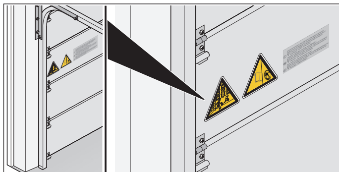
1.2 ábra: Matrica elhelyezése a kapulapon
